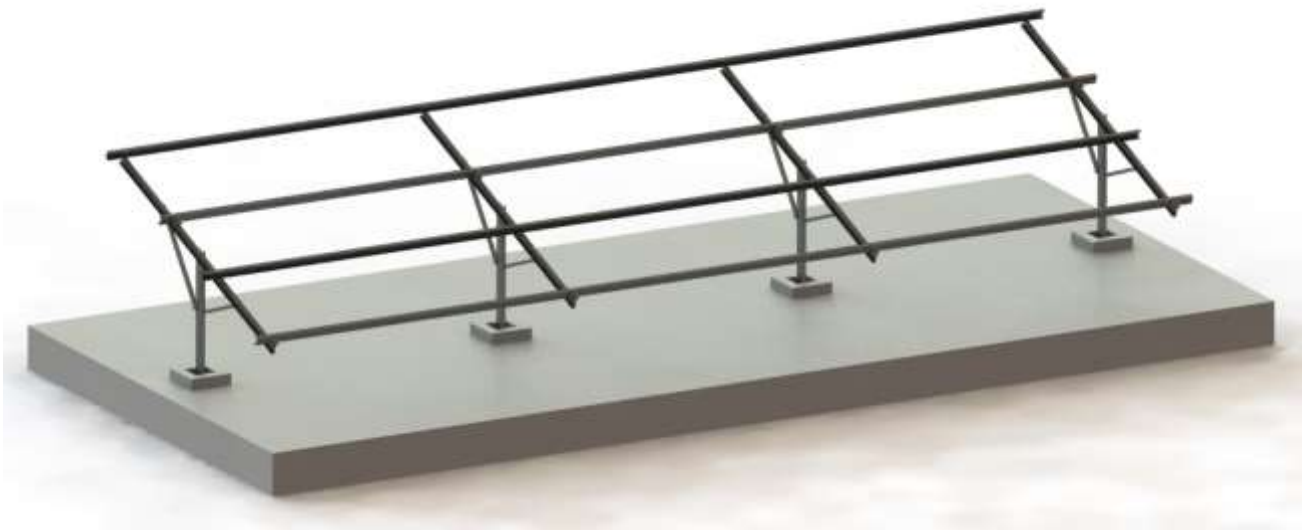
Figura 10 - Montagem das terças laterais e centrais nos fixadores.
