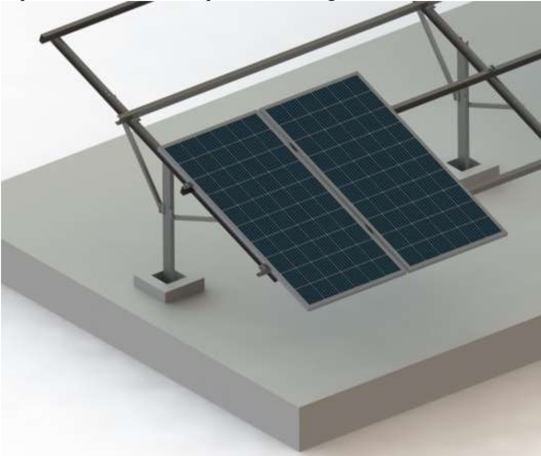
Figura 13 – Montagem do 2º módulo.
